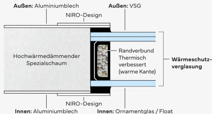
Jeweils ein Glashalterahmen in Niro-Design fasst die Wärmeschutzverglasung innen und außen ein. Die Abdichtung mit Silikon sorgt für zusätzliche Dichtheit.
